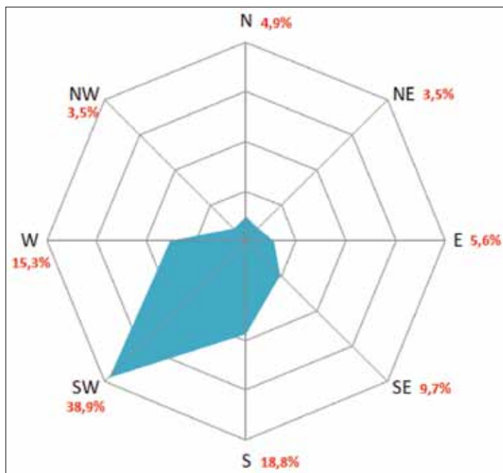
Slika 6: Vetrna roža za obdobje od 6. do 8. septembra 2010 na podlagi meritev samodejne meteorološke postaje GIS na Travljski gori na 876 m nadmorske višine.
