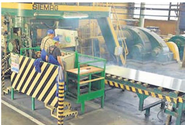
Valjanje cinkove platine danes
