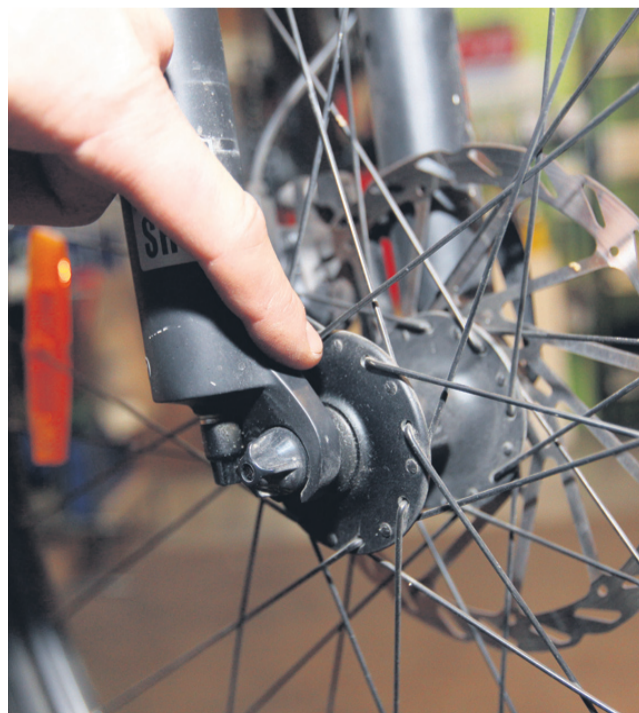
Mast, ki je v ležajih, se ob nižjih temperaturah nekoliko sprime oziroma se zgosti in nima več pravega učinka. Prihaja do obrabe ležajev. Pri nižjih temperaturah je slabše tudi vzmetenje.
