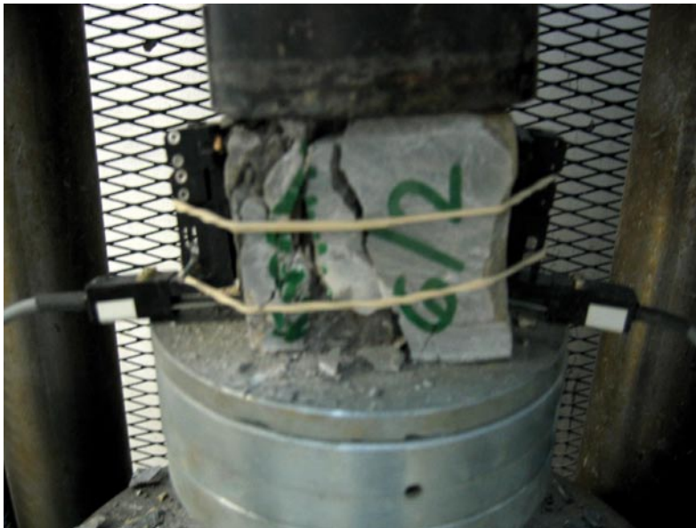
Slika 11. Nastanek razpok po preseženi vrhunski trdnosti ob cikličnem obremenjevanju intaktnega vzorca s hkratnimi meritvami deformacij
