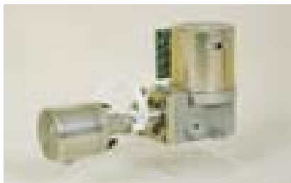
Slika 7. Modul hlajenega PtSi matričnega IR detektorja s 320x240 elementi
