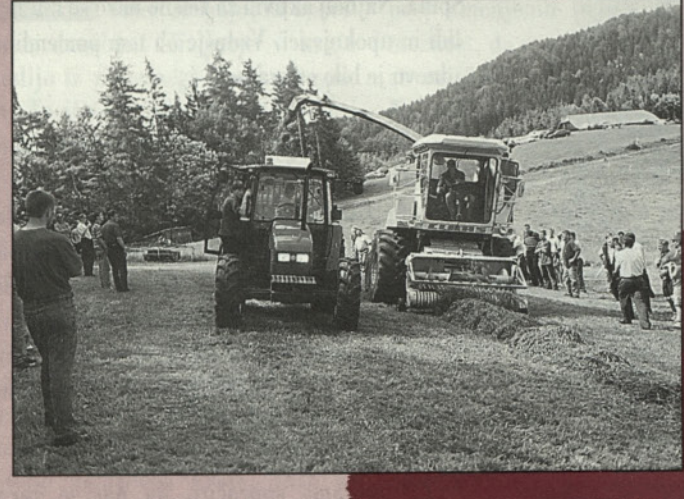
Spravilo uvele trave s samohodnim kombajnom Claas
