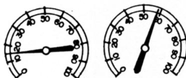
Slika 4: Primer dveh odčitkov na števcu manometra, levo dovolj vode, desno manj vode, kazalec se premika proti mejni vrednosti, ko tenziometer še deluje (85 kPa).
