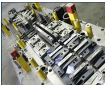
Slika 1: Progressivno štančno orodje Vir: Ero Projekt, 2020
