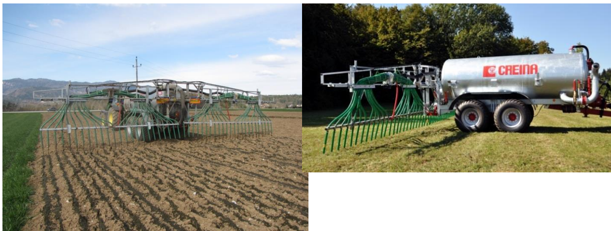
Sliki 4 in 5: Cisterna za gnojevko z napravo za vrstno razdeljevanje gnojevke (razdelilo, kjer gre tekoče organsko gnojilo skozi vlečene cevi) (Foto: Tomaž Poje, KIS in Gregor Turšič)
