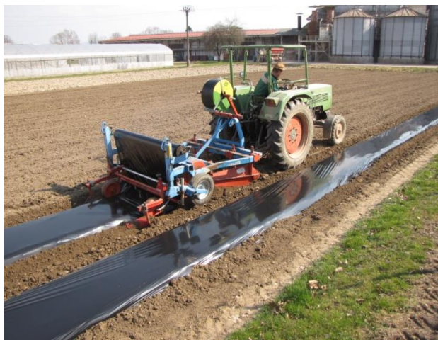
Slika 18: Z gredičarjem oblikujemo gredico in istočasno položimo folijo ter cev za namakanje (Foto: Tomaž Poje, KIS)
