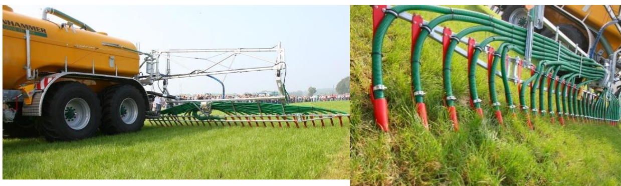
Sliki 6 in 7: Cisterna za tekoča organska gnojila z razdelilom, kjer gre tekoče organsko gnojilo skozi vlečene sani (Vir slike: Vogelsang)
