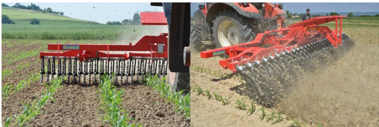
Slika 23: Okopalnik z zvezdastimi kotalnimi delovnimi elementi so namenjeni predvsem za okopavanje koruze. (Vir slike: Einboeck)
