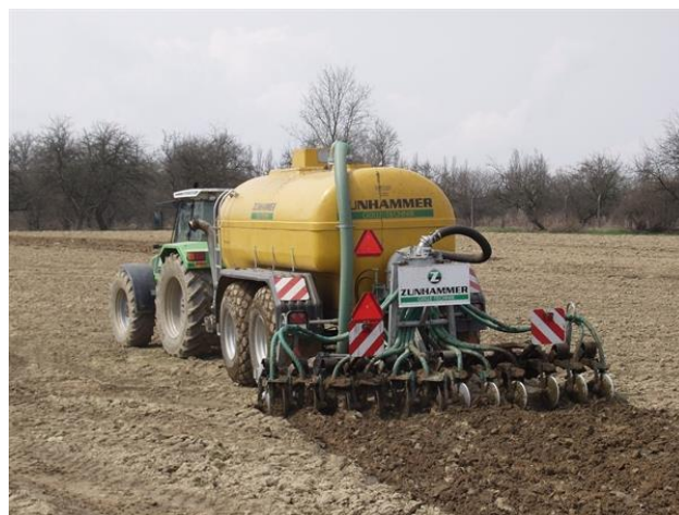
Slika 9: Razdelila s kombiniranim (združenim) strojem za istočasno obdelavo tal in nanosom tekočih organskih gnojil (Vir slike: Zunhammer)
