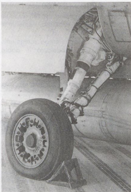
Podvozje F-16 C je enostavno, kar pa ne pomeni, da na maketi ne bi smeli dodati vodov za zavorni sistem. Tudi na prtišču bodite pozorni, saj se ta od izvedenke do izvedenke razlikujejo.
