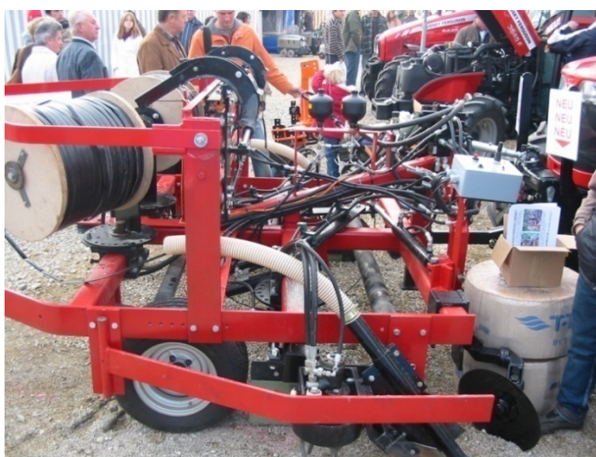
Stroj za polaganje kapljičnih cevi v vrsto – odgrne zemljo, položi cev in naredi grob. Stroj služi tudi za navijanje cevi (foto: Simon Gajšek).
