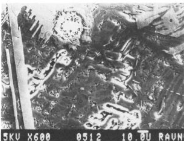
Slika 6 Mikrostruktura žilindre, 600 × Fig. 6 Microstructure of slag, magn. 600 ×.
