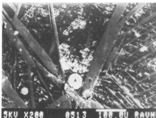
Slika 5 Mikrostruktura žilindre, 200 × Fig. 5 Microstructure of slag, magn. 200 ×.
