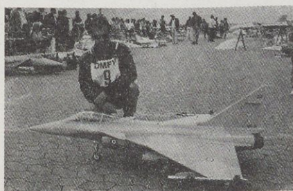
Slika 6: Scale model francoskega lovca Rafale z delastimi krili. Poganja ga ventilatorski (impeler) motor.
