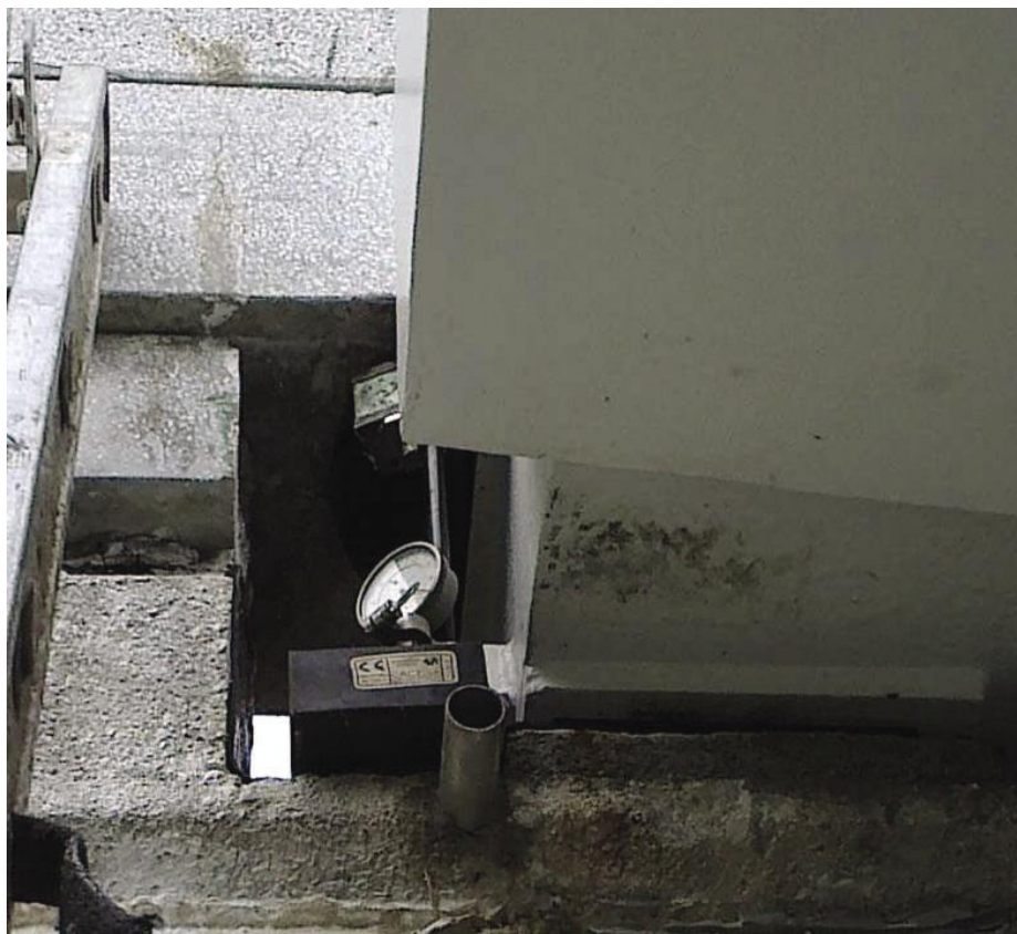
Slika 17 • Merilna urica med poskusno obremenitvijo
