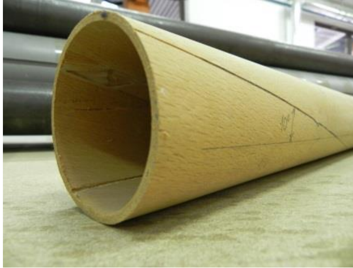
Slika 5 Primer cevnega kompozita
