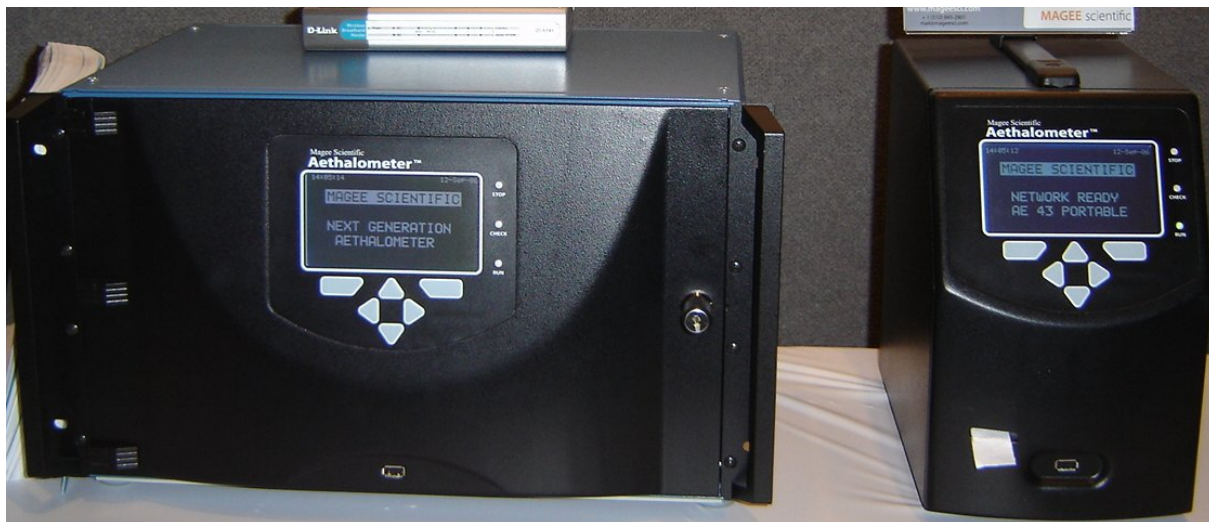
Slika 42: Prototipa novega aethalometra z zaslonom Ampire (foto: mag. Damjan Zadnik)
