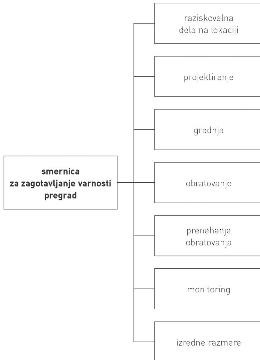
Slika 5: Vsebina smernice za zagotavljanje varnosti pregradnih objektov
