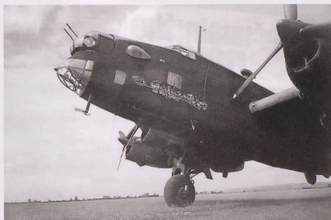
Bombnik »Ruhr Valley Express«. Sprednji rob krila (in repnih površin) je premazan z rumenkasto pasto proti zmrzovanju.
