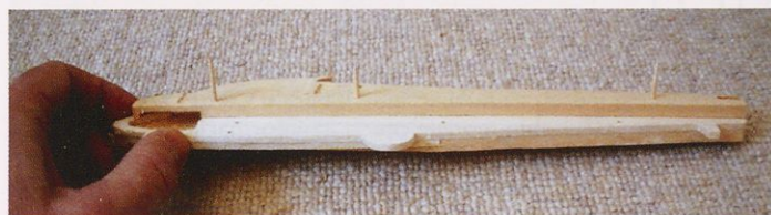
Slika 3. Avtor je povečal odprtino namenjeno uravnoteženju položaja masnega središča modela.
