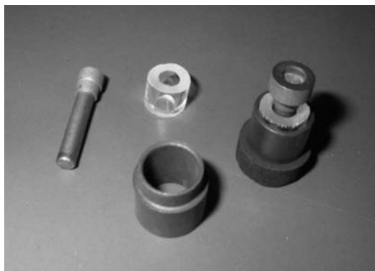
Sl. 4. Deli pripravljene za izdelavo prevodnice s stalitvijo stekla Fig. 4. Pieces prepared for feedthrough manufacturing
