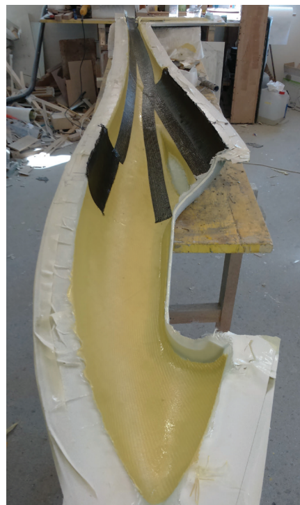
Izdelava prvega trupa. Trup je v celoti izdelan iz kevlarških vlaken in ojačan z UD-karbonskimi trakovi. Za prototip smo želeli malo močnejši in s tem trdnjši model. Naslednji bodo lažji oziroma vsakokrat po želji posameznega modelarja.
