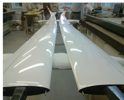
Izdelana krila, pri katerih se lepo vidi kakovostna končna obdelava, ki jo dosežemo z vnovičnim barvanjem kril in poliranjem. Vse to zahteva veliko dela, a so površine take, kot morajo biti.
