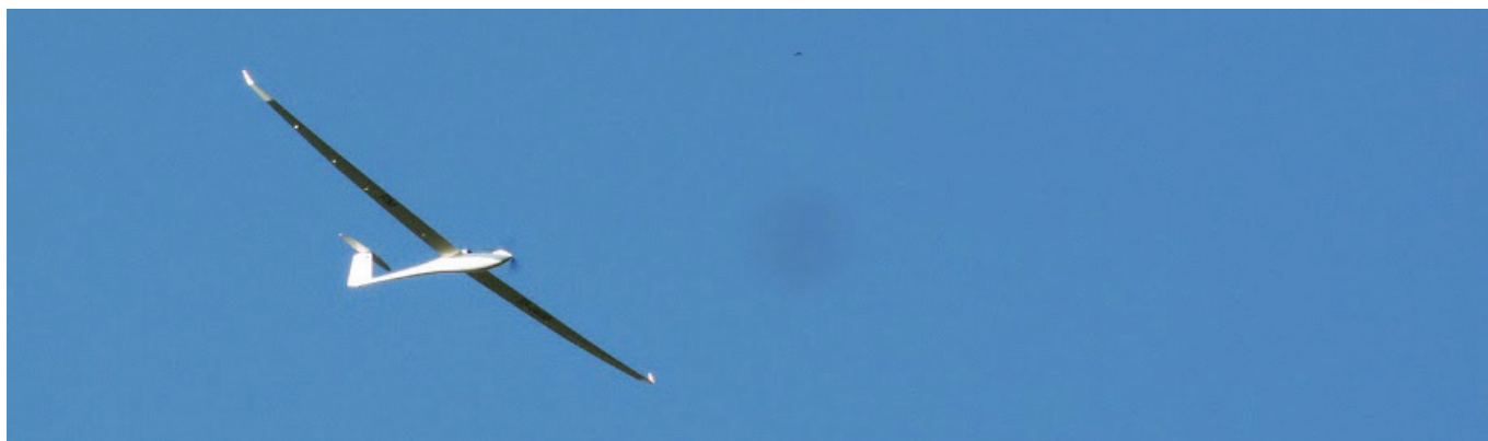
Jonker v preletu z vklopljenim elektromotorjem, ki ga bo s povprečno hitrostjo dviganja 5 m/s ponesel še kakih 350 m višje. Model se s konstantnim kotom mirno dviga na zeleno višino.
