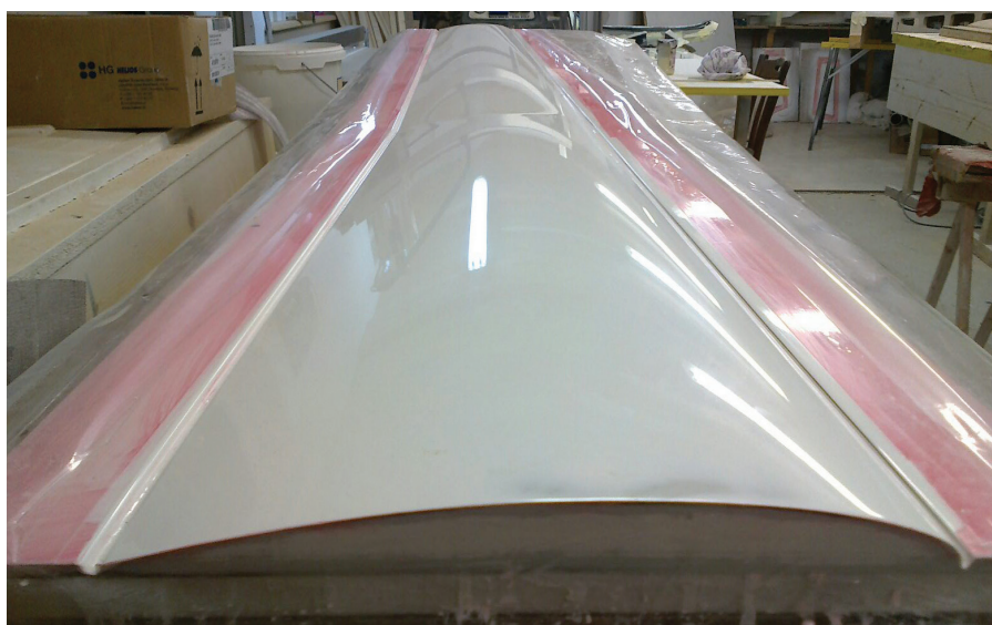
Pramodel zgornjega dela leve polovice notranjih kril je obdelan in pripravljen za izdelavo kalupa.
