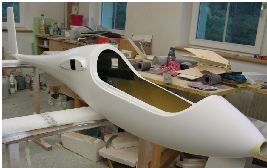
Trup prototipa je pripravljen za končno montažo. Podvozje je že vgrajeno. Nos trupa je odrezan in pripravljen za vgradnjo električnega pogona »FES« s 6-stopinjskim negativnim kotom, ki mu bomo verjetno dodali še kakšno stopinjo, saj je kot vzpenjanja še nekoliko prestrm.
