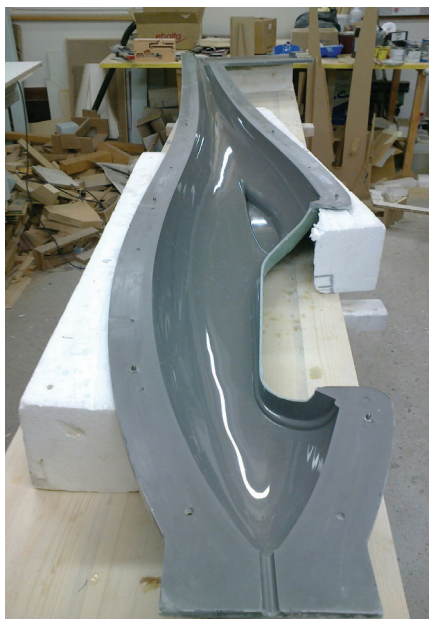
Kalup za trup je odlično uspel, kar je rezultat prav tako izvrstnega pramodela in pravilne uporabe materialov.
