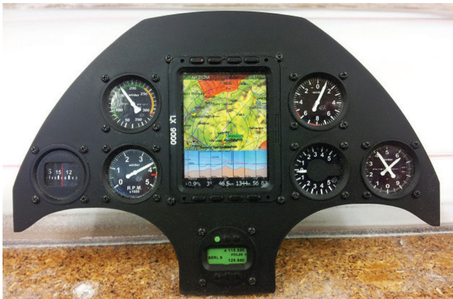
Instrumentna plošča podjetja LX navigation iz Slovenije, ki izdeluje instrumente za jadralna letala, je v modelu popolnoma enaka kot v pravem letalu.
