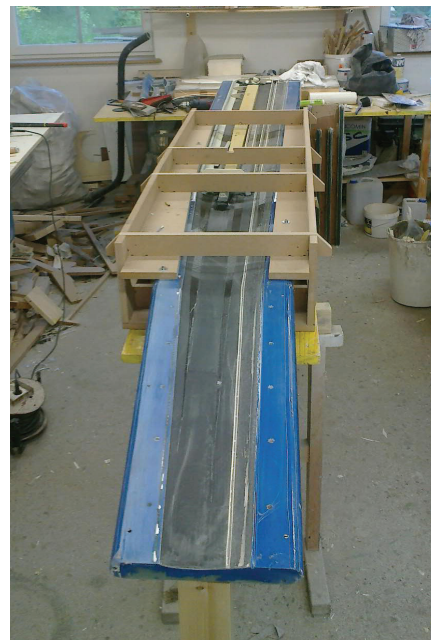
Gradnja kril v kalupih. Vidna je osnova CFK s polnilom, na katero bodo nameščene zavore, nosilci in osnove za krmilne površine, skratka obilica stvari, ki jih je treba postaviti na svoje mesto, preden spojimo zgornjo in spodnjo polovico kril.
