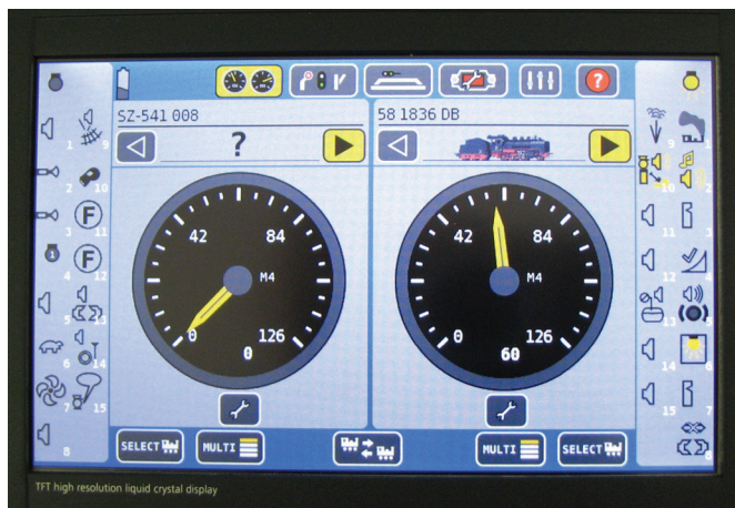
Dekodirnik v modelu omogoča ESU-jevi ali Märklinovi digitalni centrali, da samodejno prebere vseh 16 funkcij. ESU-jeva centrala prepozna dekodeer pod oznako M4.
