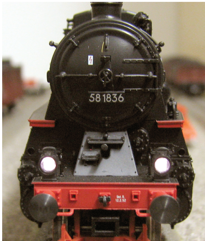
Na sprednjem delu lokomotive sta vgrajena dva velika žarometa, v katera prihaja svetloba po svetlobnem kanalu. Pod lučmi in nosilnim okvirjem je vdela kinematika z nosilcem sklopke NEM 362.
