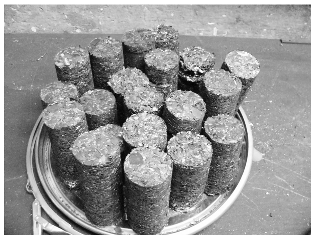
Figure 3: Compacts of stainless steel chips after cold pressing Slika 3: Stisnjeni ostružki nerjavnega jekla po hladnem stiskanju
