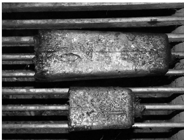
Figure 6: Ingots composed of basic steel and added compacts Slika 6: Ingota, sestavljena iz osnovnega jekla in dodanih stisnjencev
