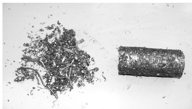
Figure 2: Separated stainless steel chips and compacted, cold pressed chips Slika 2: Ločeni ostružki nerjavnega jekla, hladno stisnjeni ostružki
