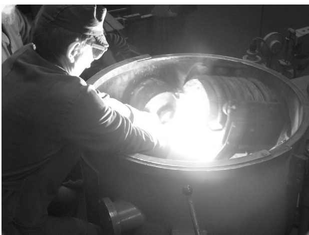
Figure 5: Casting of sample for chemical analysis Slika 5: Ulivanje vzorca za kemijsko analizo
