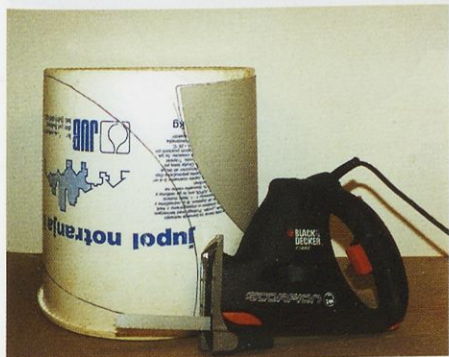
Slika 7. Poleg večnamenske žage Scorpion je za žaganje plastike primerna tudi vsaka električna vbodna žaga, v katero vpnete list za žaganje kovin.
