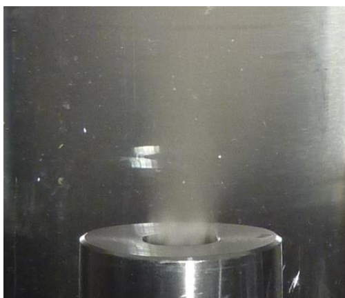
Slika 1: Kavitacijski oblak v reakcijski komori pri čiščenju vode, onesnažene z organskimi onesnažili.
