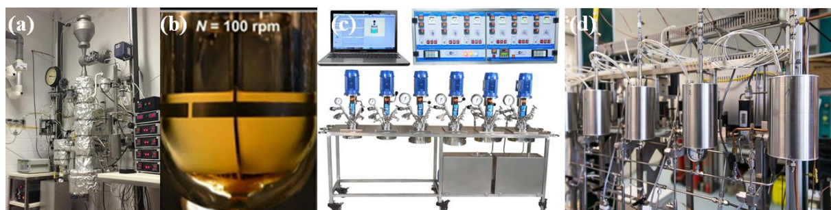
Slika 3: Reaktorji za (a) parni reforming s sorpcijo CO 2 na CaO, (b) transesterifikacijo rastlinskih olj, (c) utekočinjanje in visokotlačno HDO biomase, (d) sintezo metanola iz dimnih plinov termoelektrarn;
