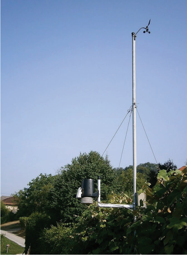
Zunanja enota: vetromer je na višini cca 5,5m, dežemer, vlagomer, temperaturni senzor pa na 2,3 m, foto Matej Štegar.
