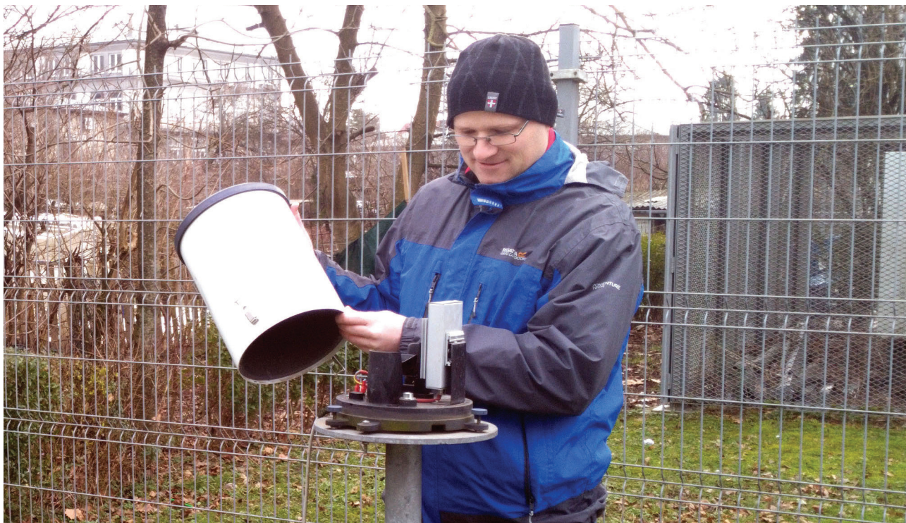
Gregor Skok pri pregledu dežemera samodejne meteorološke postaje na fakulteti za matematiko in fiziko, foto: osebni arhiv.
