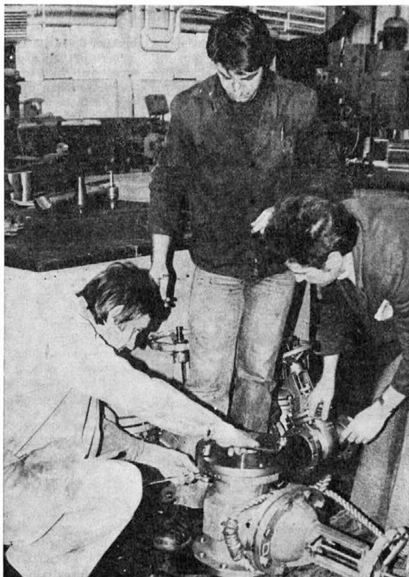
Montaža zasuna v orodjarni
