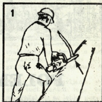
slike št. 1, 2, 3 Prikaz kleščanja leve strani venca, puščica nakazuje smer reza
