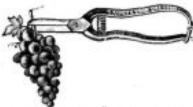
Podoba 55. Škarje za trganje namiznega grozdja, ki odrezani grozd same držijo (prezentne škarje).
