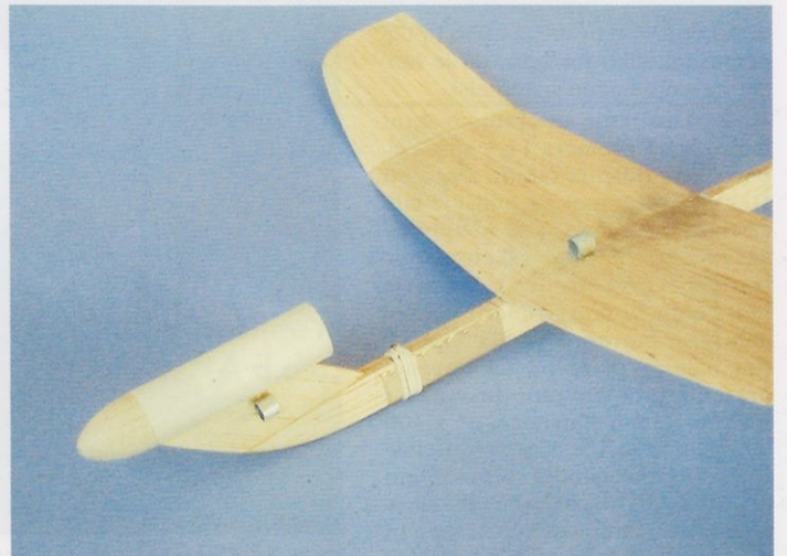
Slika 8. Ena od možnih namestitev vodil na model raketoplana
