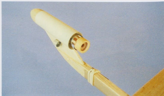
Slika 9. Pred štartom trak ovijemo okoli motorja in motor vstavimo v nosilec le toliko tesno, da ne izpade, ko ga postavimo navpično na lansirno rampo.
