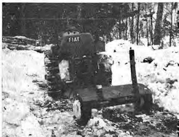
Slika 4. Traktor fiat 411-C z dvokolnim spravlilnim na- slonom (orig.)
