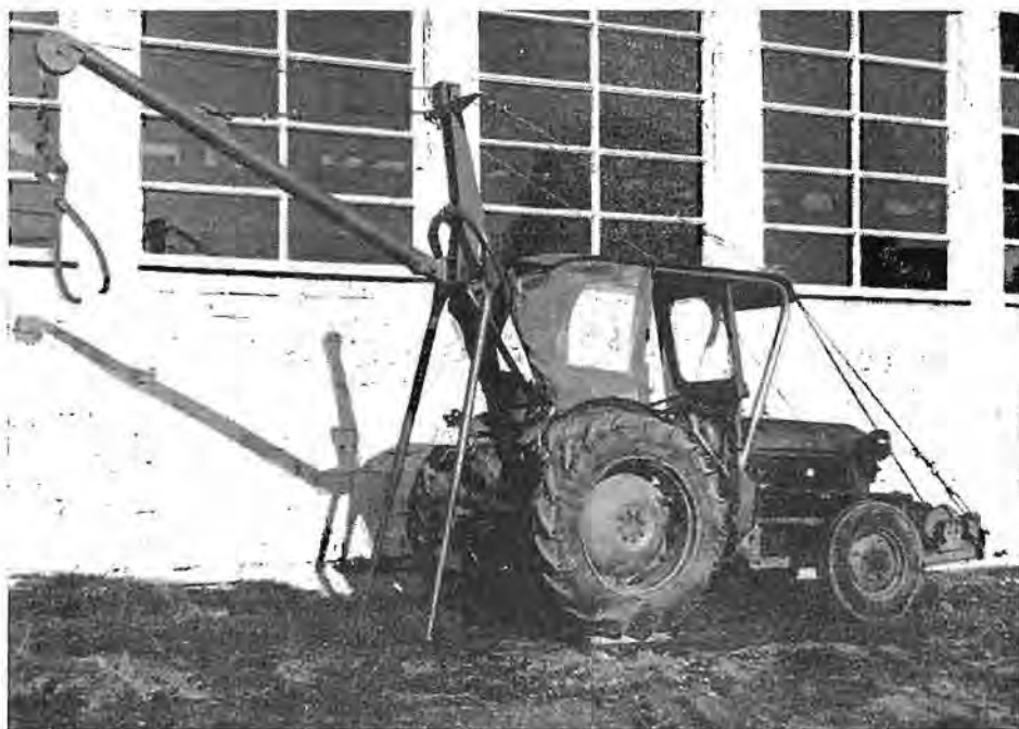
Slika 3. Stranski pogled na traktorski mehanični žerjav TMŽ-1
