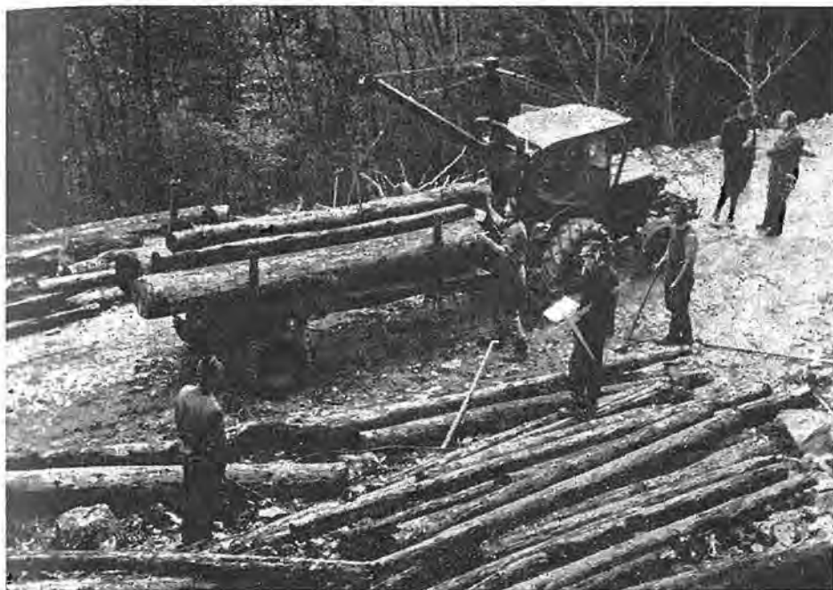
Slika 4. Nakladanje daljšega lesa s pripravo TMŽ-1
