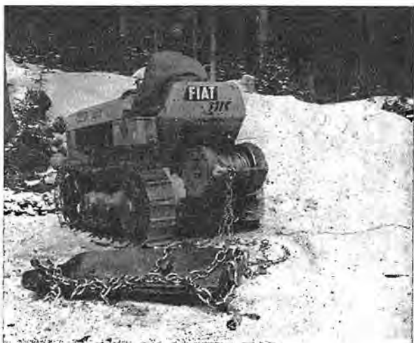
Slika 3. Sankalna plošča kot priključek za povezovanje in pritegovanje tovara (foto: Krivec)
