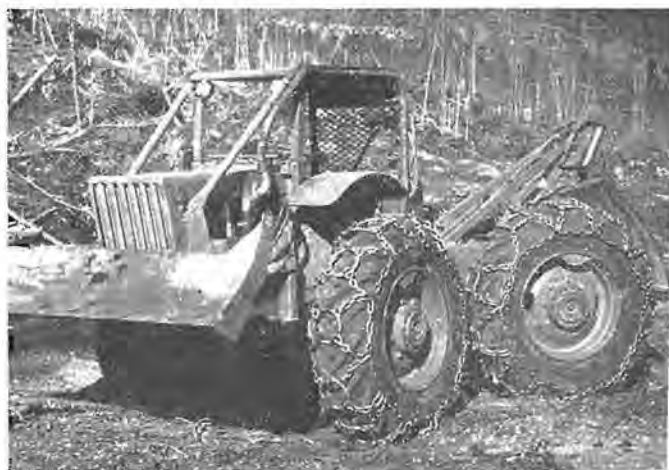
Slika 2. Obračanje sodobnega traktorja (tree farmer). Na prednjem delu je opremljen s plužno desko (orig.)
