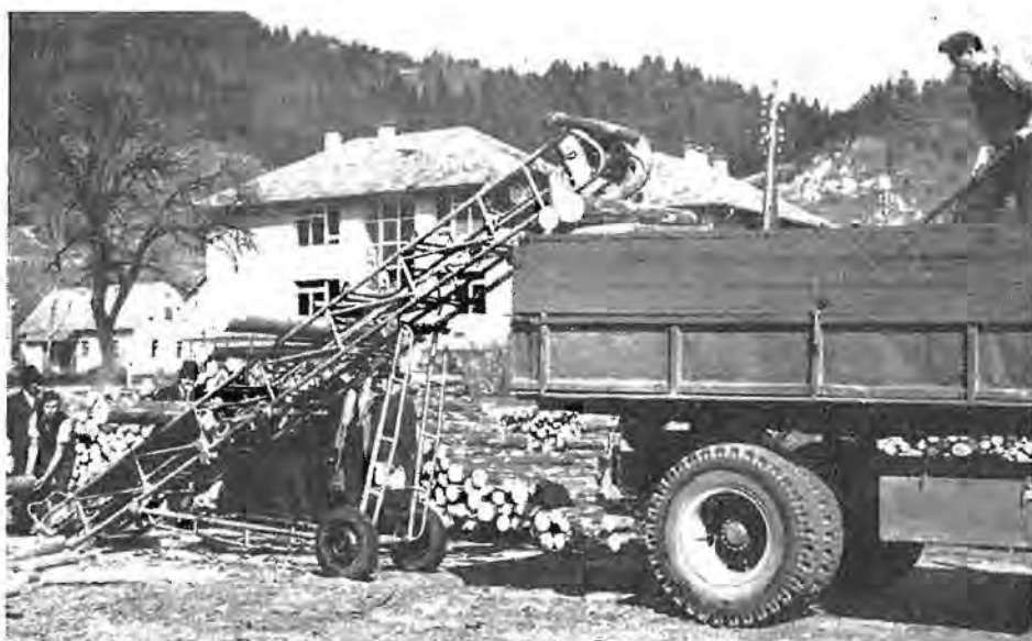
Slika 7. Nakladanje 2-metrskih okroglic s transporterjem na kamion
