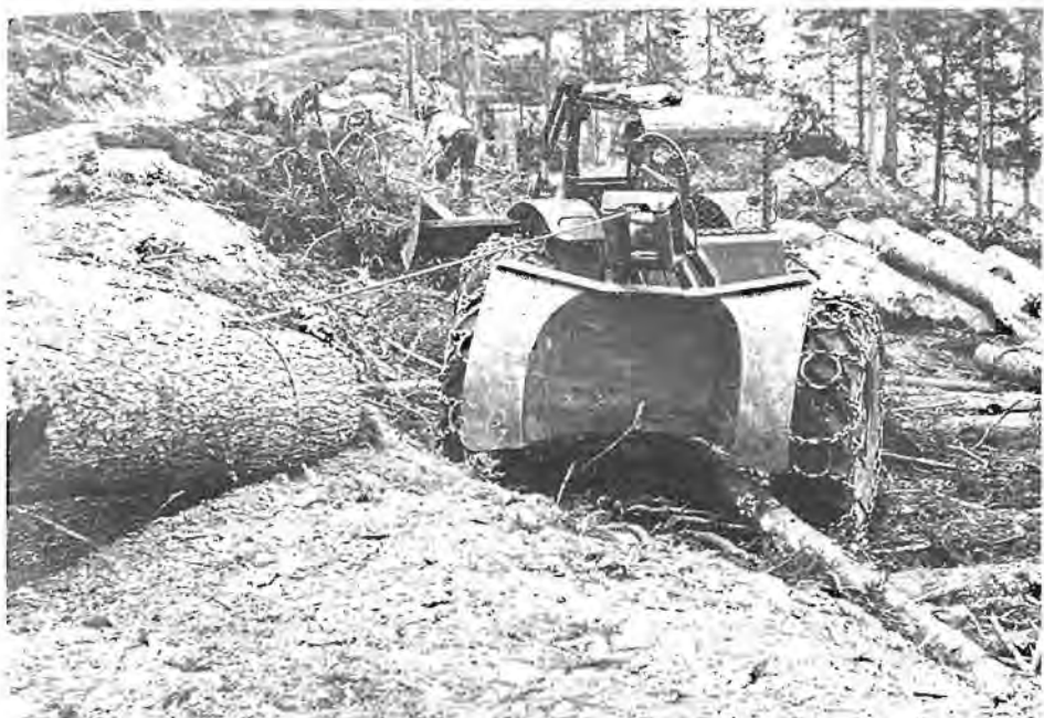
Slika 3. Na zadnjem delu ima traktor tree farmer zaščitno desko, ki varuje njega in ljudi pri zbiranju lesa z vitlom (foto: Pestal)
