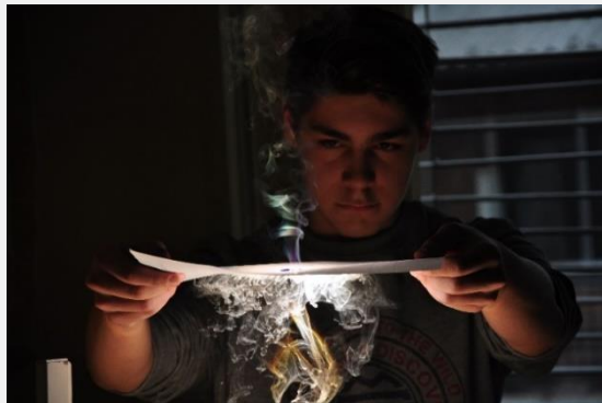
Slika 2: Iskanje gorišča zbiralne leče grafoskopa s papirjem in počrnjeno piko - za boljšo absorpcijo svetlobe.
