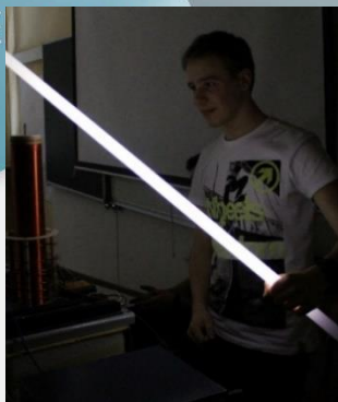
Slika 1: Visoka napetost iz Teslovega transformatorja vzbudi sevanje atomov plina v cevi (žarnici).
