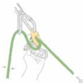
Slika 3-A: Razbremenjevanje avtoblokirnega varovala (nove naprave)
