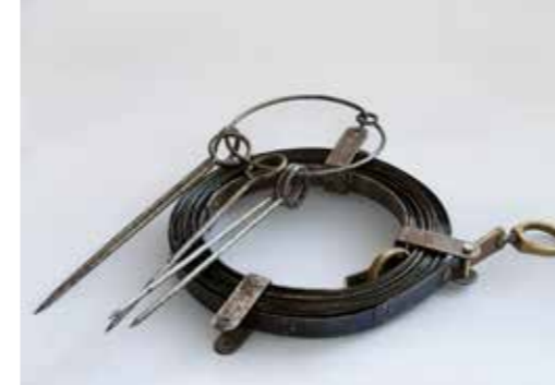
Jekleni merski trak s števnimi ali markirnimi ključi se je uporabljal že od leta 1880 naprej. Hrani Geodetska uprava Republike Slovenije. Steel measuring tape with marking pins, about 1880. Kept at the Surveying and Mapping Authority of the Republic of Slovenia.
