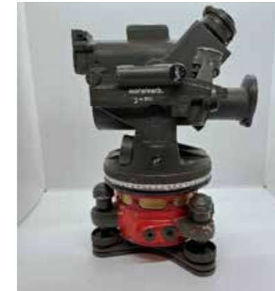
Vojaški instrument Nadelverb R. K. 12m beh 1349 KF , 1930 do 1935. Hrani Park vojaške zgodovine v Pivki. Nadelverb R. K. 12m beh 1349 KF German bunker construction theodolite, 1930 to 1935. Kept at the Park of Military History Pivka.
