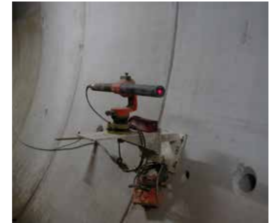
Laserska usmerjevalna naprava na zadnji točki operativnega poligona. Alignment laser at the endpoint of the main traverse.
