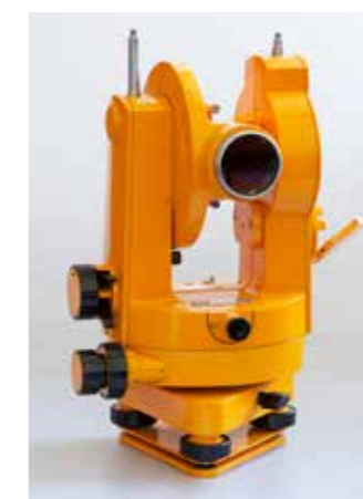
Avtoredukcijski tahimeter Dahlta 010 B , 1980. Hrani Tehniški muzej Slovenije, Slovenska geodetska zbirka. Inv. št. / Inv. no. 800:LJU;0008608 Dahlta Dahlta 010 B self-reducing tacheometer, 1980. Kept at the Technical Museum of Slovenia, Slovene Geodetic Collection.
