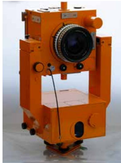
Terestrična analogna fotogrametrična kamera UMK 10/1318 (Carl Zeiss Jena). Terrestrial photogrammetric camera.
