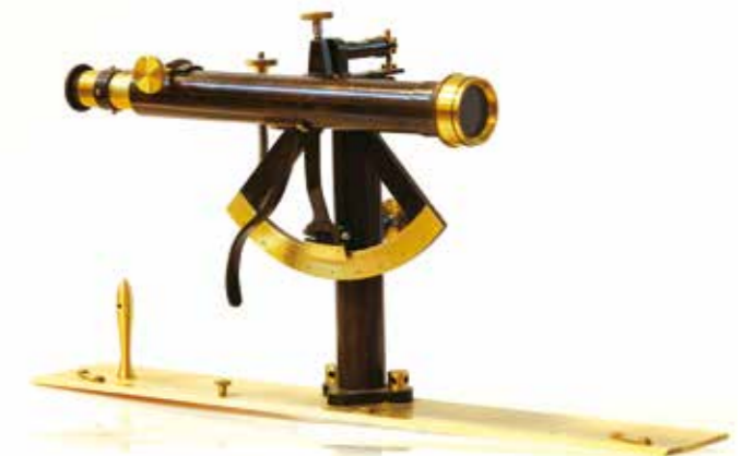
Kipregl je instrument, ki se je uporabljal v prvih desetletjih vzdrževanja katastrskega operata. A telescopic alidade is an instrument used in the first decades to maintain the cadastral record.
