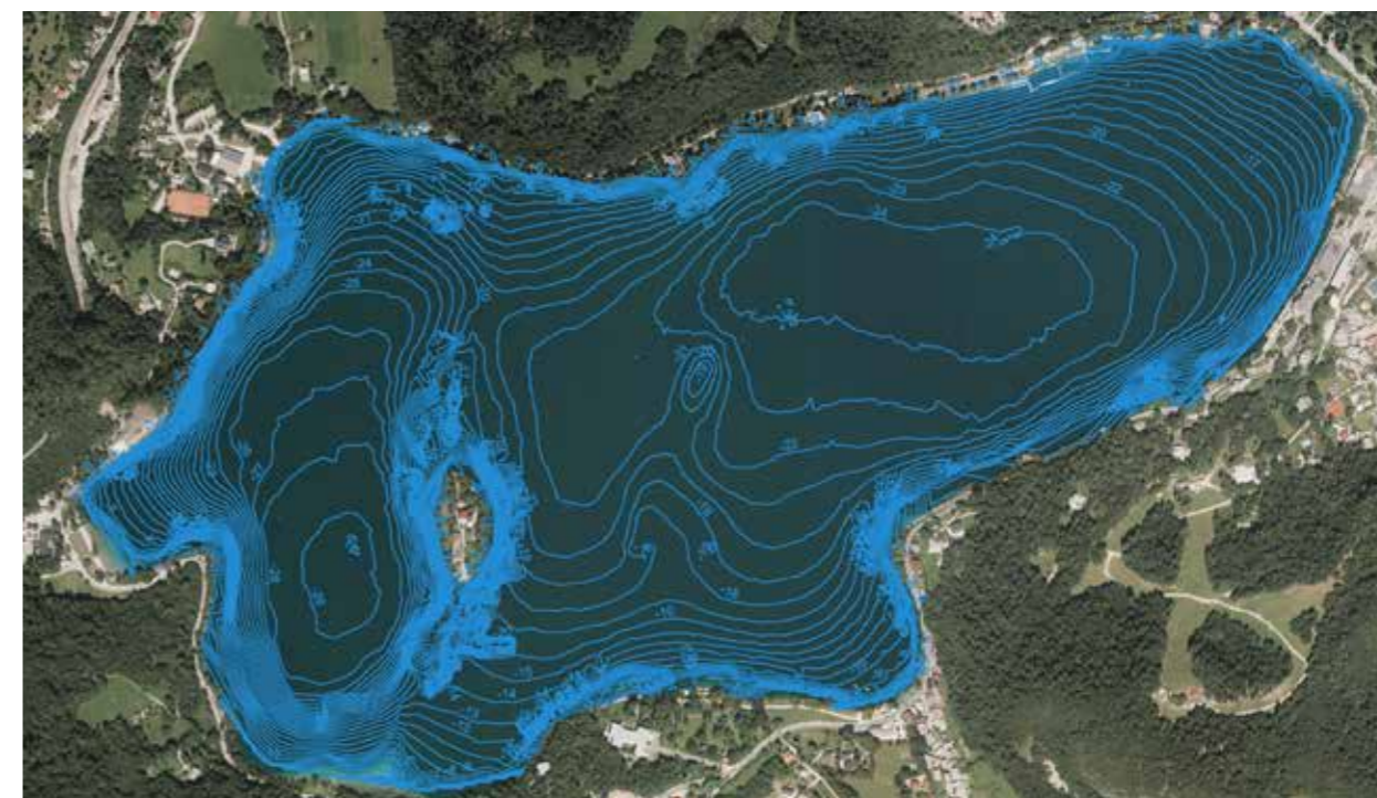
Prikaz globin Blejskega jezera z izobatami na podlagi DOF – ekvidistanca izobat je 1 m. Bled Lake's relief represented as depth contours or iso-baths (digital orthophoto) – isobaths' equidistance: 1 m.
