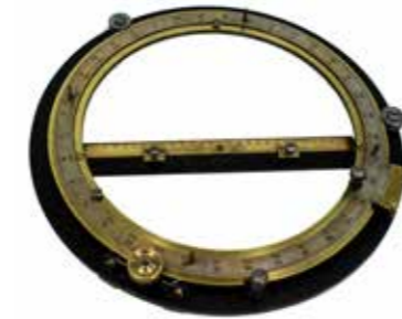
Krožni polarni transporter ali polarni koordinatograf Gebrüder Fromme , okoli 1890. Hrani Tehniški muzej Slovenije, Slovenska geodetska zbirka. Inv. št. / Inv. no. 800:LJU;0008574 Gebrüder Fromme circular protractor, about 1890. Kept at the Technical Museum of Slovenia, Slovene Geodetic Collection.
