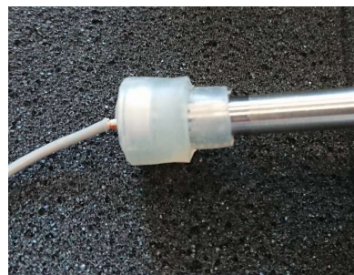
Slika 4. Fotografija akustičnega sklopnika z elektrostatičnim zvočnikom in merilnim mikrofonom B&K tip 4135.
