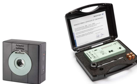
Slika 1. Akustični kalibrator tip 4231 (levo) in tip 4226 (desno) [3, 4].
