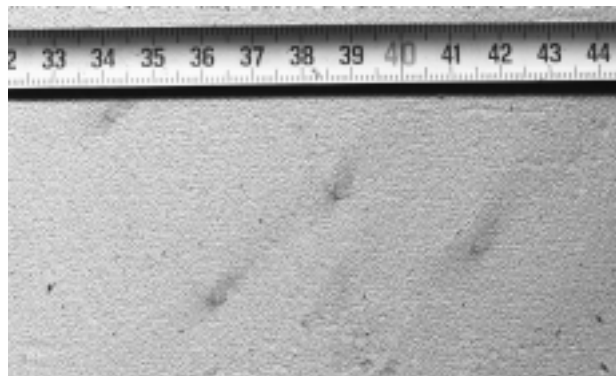
Slika 1: Napake na površini debele pločevine (jeklo SS2343, legirano z žveplom)
