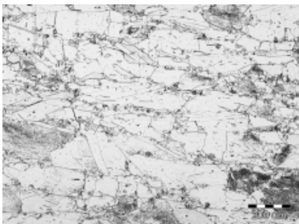
Slika 7: Vzorec, hlajen na zraku (1100 °C, 24-odstotna redukcija – vrsta jekla SS2343)
