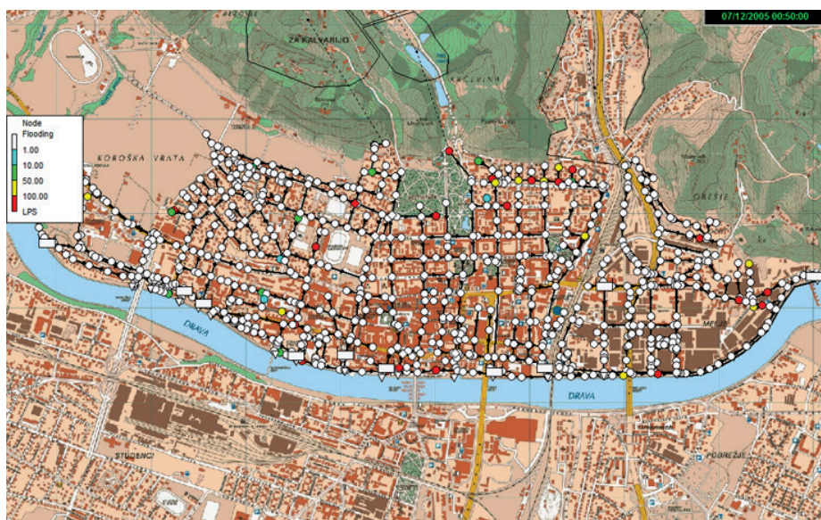
Slika 10 • Hidravlični izračun z modelom SWMM za levi breg Maribora, ki prikazuje izlivanje kanalizacije za nalive povratnih dob 2 in 5 let (IEI, 2008).
