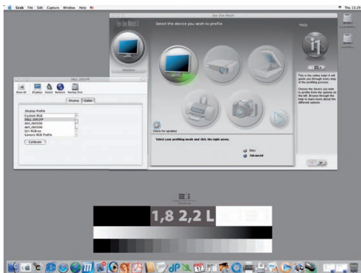
Slika 18. Preden začnemo kalibrirati, moramo v operacijskem sistemu nastaviti 32-bitni barvni prostor (barvno globino), da računalnik na zaslonu upodobi 16,7 milijona barv, primerno ločljivost, ki mora pri monitorjih LCD ustrezati zasloni, in generični ali privzet barvni profil RGB za dani tip monitorja. V programu Eye-One Match 3.6 nato izberemo način kalibracije. Ker vemo, kaj hočemo narediti, se odločimo za »Advanced«.
