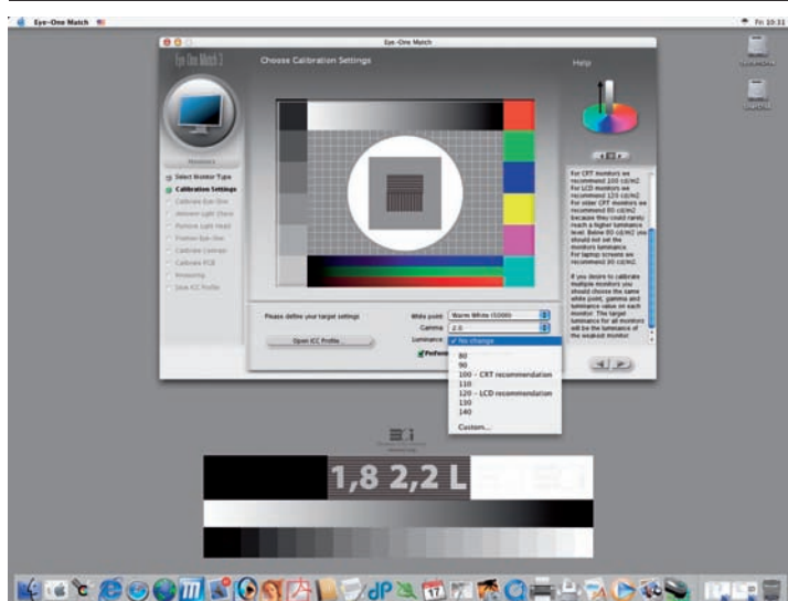
Slika 24. Svetilnost (luminance) ostane naravna, če želimo monitor zgolj profilirati, sicer za monitorje CRT priporočajo 100, za LCD pa 120 cd/m 2 . Mnogi starejši monitorji ne dosežejo več kot 80, notesniki ne več kot 90 cd/m 2 . V takih primerih moramo izbrati na vseh monitorjih v skupini svetilnosti najšibkejšega in poskrbimo, da so tudi barvne temperature in gradacije na vseh enake.
