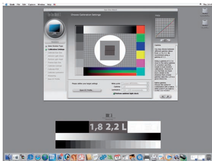
Slika 23. Gradacijo ali gamo izbiramo med 1,0 in 3,0; priporočajo gamo 2,2, ker je najbližje naravni gradaciji sodobnih monitorjev, zlasti LCD. Na starejših računalnikih z monitorji CRT, predvsem če so Macintosh, bomo raje uporabili gradacijo 1,8. Bližje ko je zelena gradacija naravni, bolj uravnoteženo bi moral biti monitor kalibriran.
