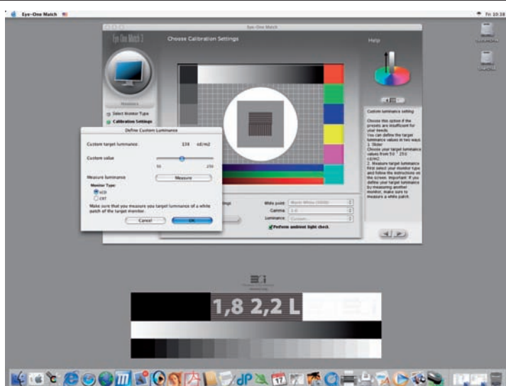
Slika 25. Svetlost zaslona lahko nastavimo po svojih potrebah, denimo tako, da ustreza svetilnosti kakšnega drugega monitorja. Tam jo na belem polju izmerimo s spektrofotometrom (Spectrolino, Color-Eye Display 2). Praksa kaže, da so monitorji LCD ob priporočeni svetilnosti 120 cd/m 2 presvetli in je bolje nastaviti 100–110 cd/m 2 .
