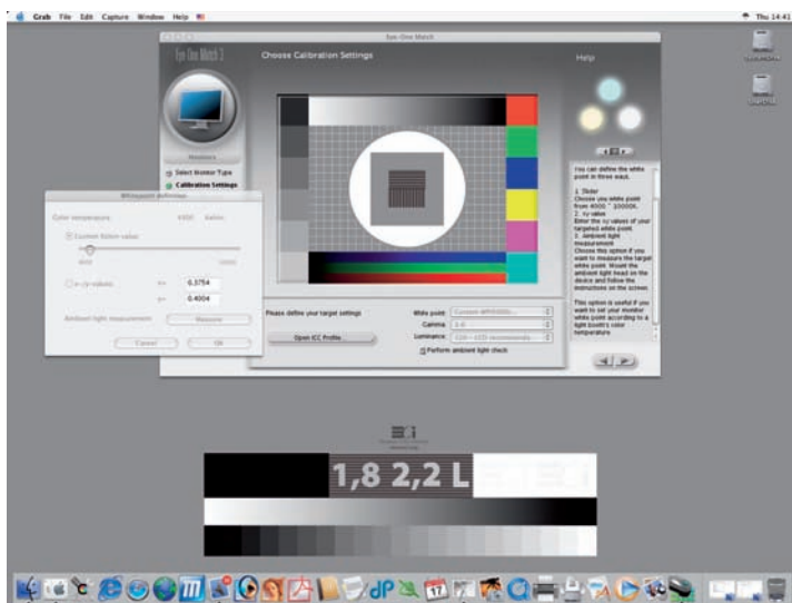
Slika 22. Merjenje s spektrofotometrom je uporabno, ko želimo popolnoma izenačiti beli barvi zaslona in svetlobe v prostoru ali denimo v svetlobni kabini. Seveda je tak postopek primeren le pri izvedbi kakšnih prav specifičnih ali zelo zahtevnih projektov, drugače pa je bolje, da se držimo standardov.
