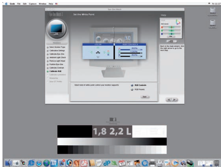
Slika 30. Kalibracija barvne temperature. Glede na vrsto monitorja izberemo privzete nastavitve RGB ali ročno nastavljanje (RGB controls), da bi dosegli želeno barvno temperaturo. Program prikaže tudi želeno in izmerjeno svetilnost zaslona.
