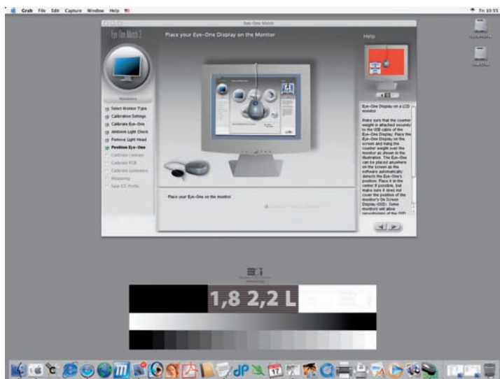
Slika 28. Kalibracija poteka v treh korakih: najprej kontrast, potem barvna temperatura in končno svetlost. Spektrofotometer smemo postaviti kamor koli, kajti program sam prepozna njegovo pozicijo. Vseeno je najbolje, da je v sredini zaslona ali tam, kjer najpogosteje opazujemo slike.
