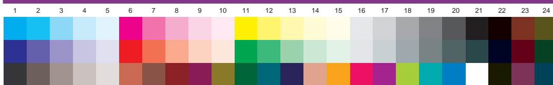
Slika 19. Novi medijski klin Ugra/Fogra-Medienkeil-CMYK-EPS V3.0 Proof. Namesto dosedanjih 46 barvnih polj jih ima 72, ker so mu dodali dvanajst 10- in 20-odstotnih rastrskih polj, pet tribarvnih polj CMY brez sivega ravnovesja, tri polja, kjer se obenem s črno tiskajo posamične osnovne barve, in šest polj z najtemnejšimi barvami, tako da svetlost L* ni večja od 35. S tem popolnoma ustreza standardu ISO 12647-7.
