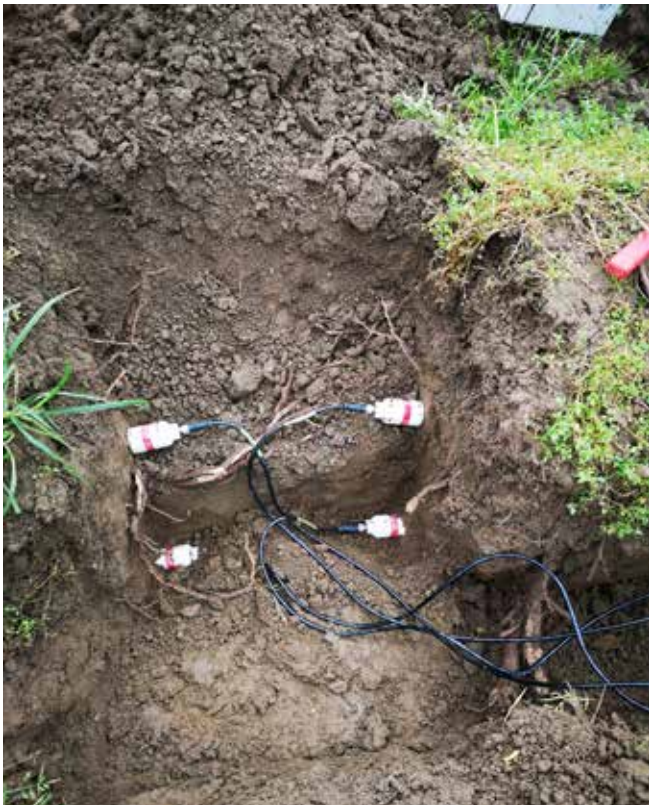
Vstavljene sonde za meritve vsebnosti vode v tleh v hmeljišču na kmetiji Jožefa Ribiča, ki v projektu nastopa kot projektni partner (Foto P. Korpar)
