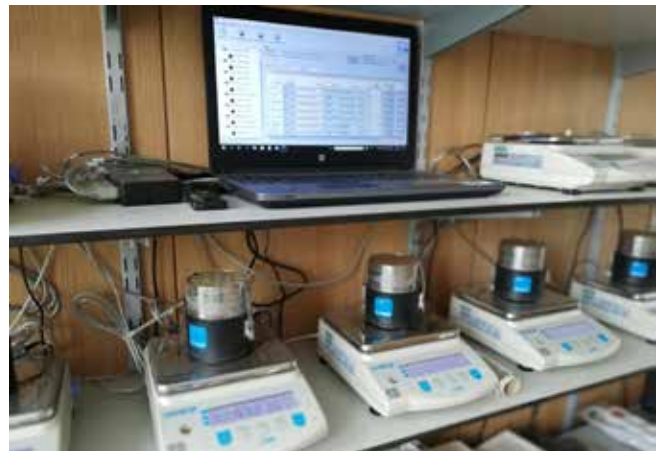
Določanje vodnozadrževalnih lastnosti tal v laboratoriju (Foto P. Korpar)
