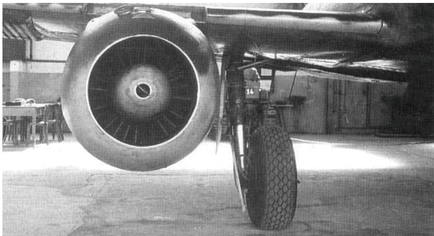
Motor od spredaj. Lepo se vidi tudi noga podvozja, ki je nagnjena malce navznoter. Na maketi s tem ni težav.
