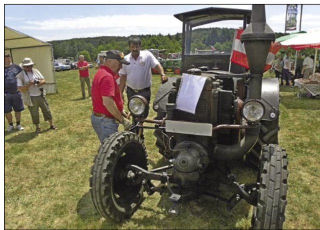
Johann Domiter z volanom traktorja letnik 1944, ki ga mora sneti za zagon motorja »z žarečo glavo«, prednikom sedanjih modernih dizelskih motorjev, ob njem organizator srečanja Drago Abraham.
