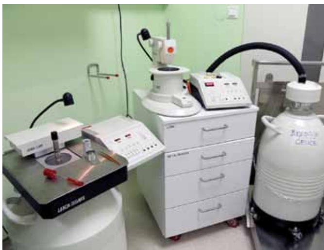
Slika 4: Napravi za udarno zamrzovanje (desno) in kriosubstitucijo (levo). Obe napravi sta blajeni s tekočim dušikom, ki se nabaja v jeklenkah (na sliki skrajno desno in pod napravo za kriosubstitucijo skrajno levo). Vir: Samo Hudoklin, Inštitut za biologijo celice, Medicinska fakulteta Univerze v Ljubljani.
