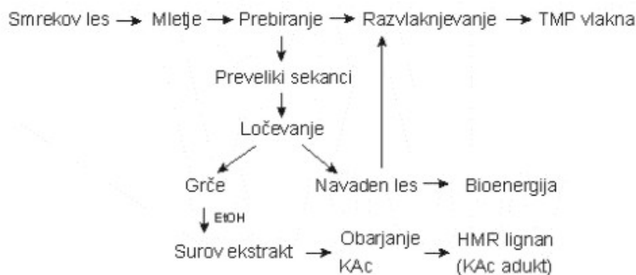
Slika 5: Proizvodnja HMR iz navadne smreke (Holmbom et al. , 2007)
