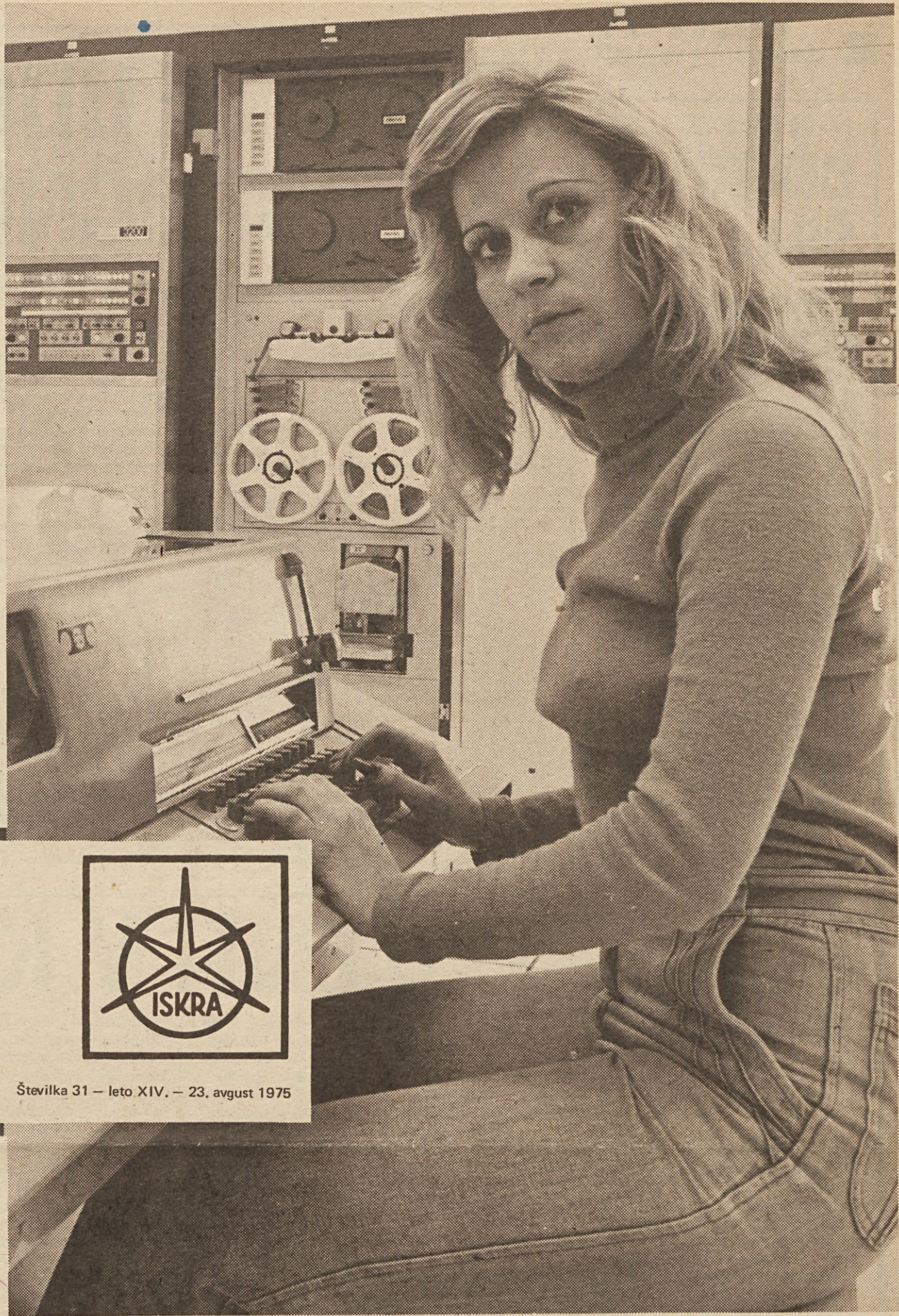
„Centralo preizkusimo z računalnikom in preizkusnimi programi,“ pravi Liljana Ranković, ki preko teleprinterja vnaša podatke za prilagoditev in aktiviranje preizkusnih programov. (Več o tem berite na 4. in 5. strani!)
