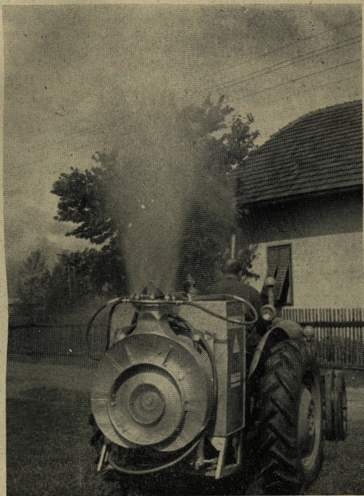
Traktorski molekulator TFM 300, urejen za škropljenje hmeljišč, ko je hmelj dosegel višino žičnice.
