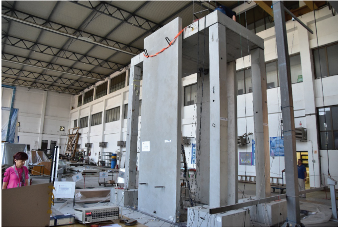
Slika 8. Testi fasadnih panelov v naravnem merilu, izvedeni na potresni mizi IZIIS v Skopju.
