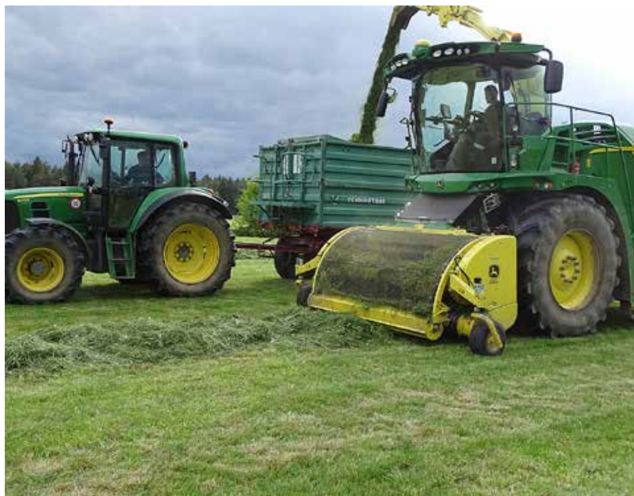
Pobiralna naprava za travo John Deere 639 je široka tri metre, tehta pa dobro tona.
