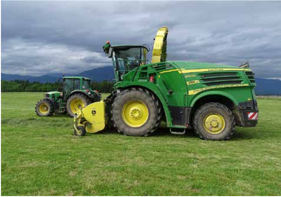
V samovoznem silokombajnu John Deere 8500i je zadaj nameščen šestvaljni 13,5-litrski motor, ki razvije po standardu ECE R120 400 kW (544 KM) nazivne moči oziroma 430 kW (585 KM) maksimalne moči.
