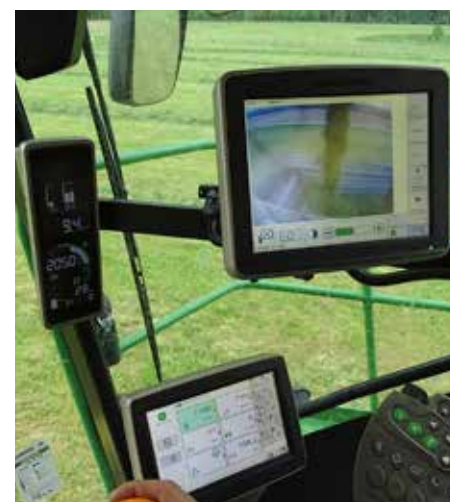
V kabini silokombajna John Deere 8500i so trije zasloni. Na njih lahko nastavljamo in spremljamo parametre stroja. Vključeno imamo lahko kamero, ki kaže, kam pada pobrana trava iz izmetalne cevi.
