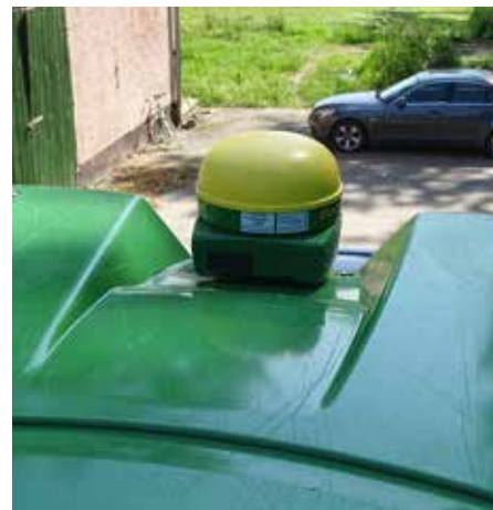
Silokombajn JD 8500i je opremljen s satelitsko anteno (sprejemnikom) John Deere StarFire 3000, s pomočjo katere določa položaj na parceli.
