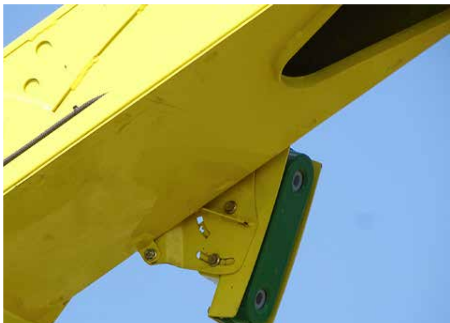
Stereo kamera nameščena na izmetalni cevi silokombajna John Deere. Njeni posnetki so osnova za delovanje sistema John Deere Active Fill Control System za samodejni nadzor vrtenja in položaja lopute izmetalne cevi.
