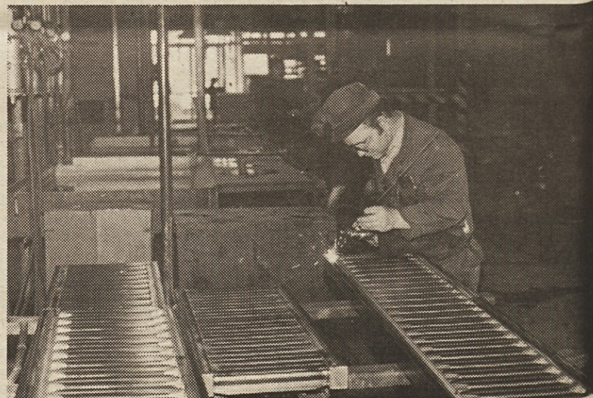
Varjenje ploščic in prirobnic z navojem na baterijo EMOTERM radiatorjev.
