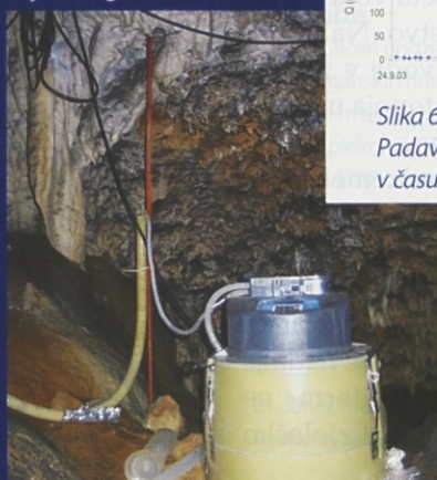
Slika 4: Pod sigovo kopo avtomatski zajemalnik vzorcev zajema vodne vzorce. Fotografija: J. Kogovšek.
