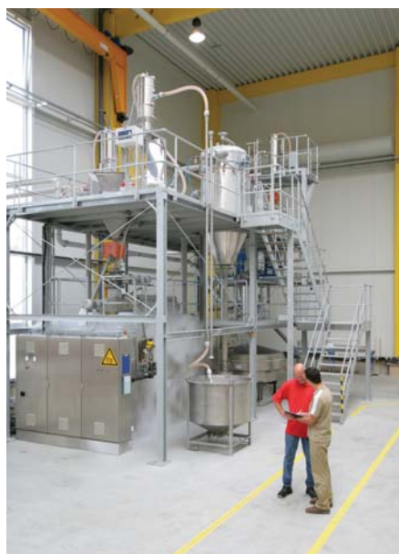
Slika 2: Linija za fino kriogensko hladno drobljenje - prah.
