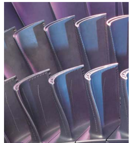
Vrhunec natančnosti: lopatice današnjih turbin so računalniško optimizirane in izdelane iz različnih zmesi, ki ščitijo pred vplivom visokih temperatur.
