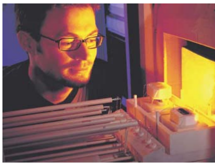
Iz laboratorija v elektrarne: raziskovalec v Siemensu meri električne lastnosti gorivnih celic.
