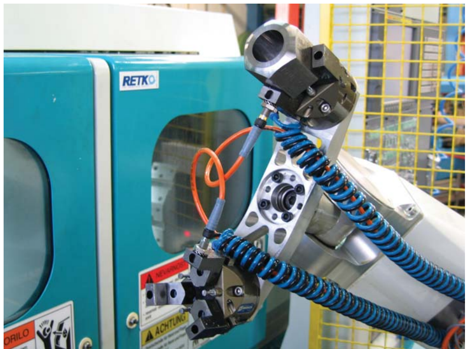
Prijemala so pomemben del uporabe robota v kosovni proizvodnji (foto: arhiv Mikron).
