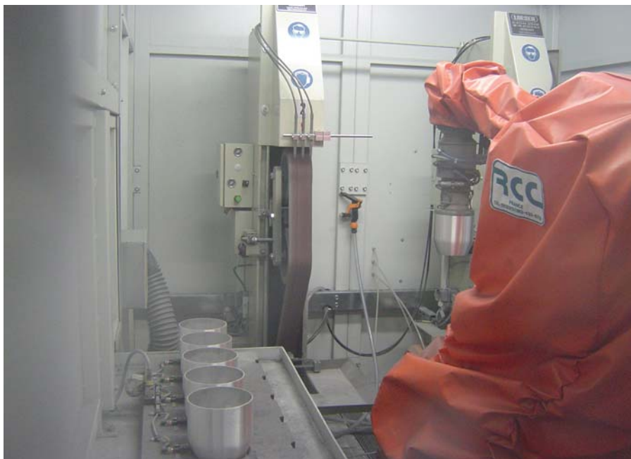
Robot pri brušenju tudi sam potrebuje zaščito (foto: arhiv Motoman Robotec)
