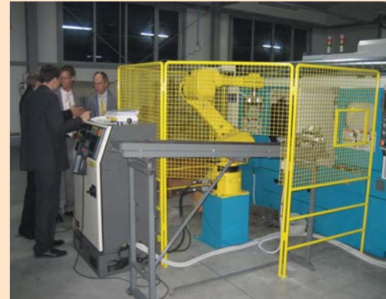
Obdelovalna celica z robotom za strego v podjetju Retko, d. o. o. Ravne na Koroškem
