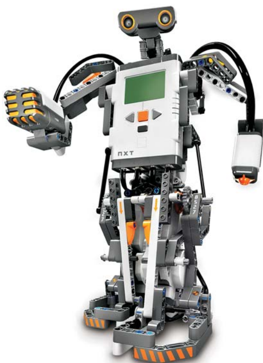
Kocka NXT s tipkami in zaslonom je srce robota nove generacije
