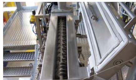
Slika 3: Komora s polžem v kateri je tekoči nitrogen.
