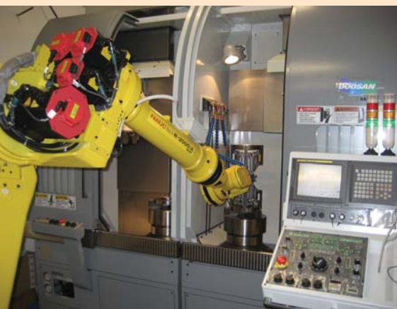
Robot 165 kg s prijemalom za strego dvovretenske vertikalne CNC-stružnice (Obdelava kovin, Franc Junc s.p., Tolmin)
