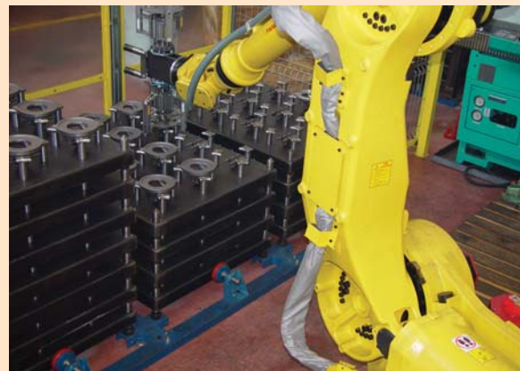
Robotizirana strega stroju v Orodjarstvu Šemrl Ivan s. p., Ptuj
