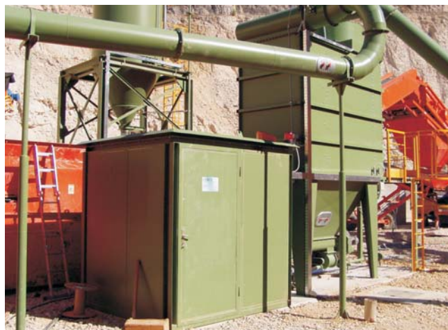
Suha filtracija zaprašenega zraka pri separaciji v kamnolomu (objekt KAMEN Učka)
