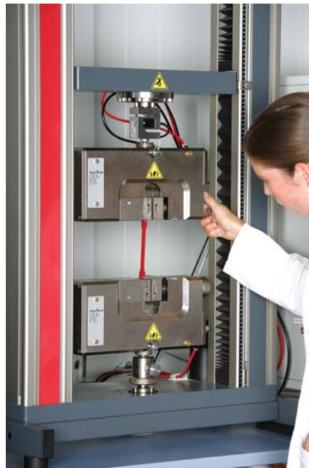
Slika 5a: Merjenje mehanskih lastnosti (natezni preizkus).
