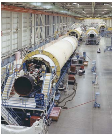
Skupna nosilna jedra Delte IV ali common booster cores CBC izdelujejo in gradijo v Boeingovi tovarni v Decaturju (Zvezna država Alabama) in predstavlja prvo stopnjo v vseh konfiguracijah Delte IV.
