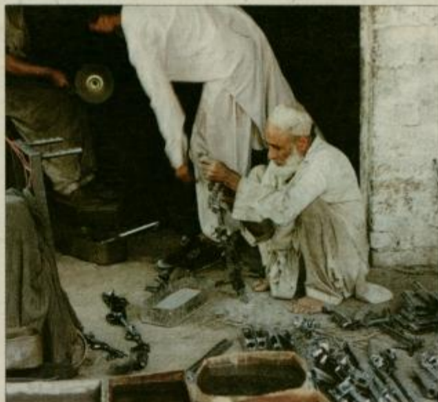
Ulična sestavljavnica kalašnikov. Mojstri v pločevinastih posodah kalijo razžarjene jeklene dele.
