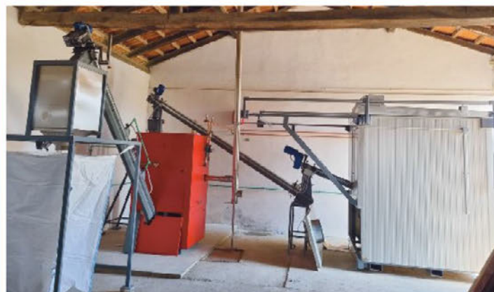
Fotografija 2: Pirolizna peč, rezultat domačega in tujega znanja, postavljena na kmetiji Vogrincev v Skorbi.
